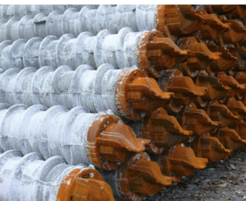
Stützen und Schraubpfähle sind die Hauptprodukte des UHPC-Produzenten Alphabeton.
